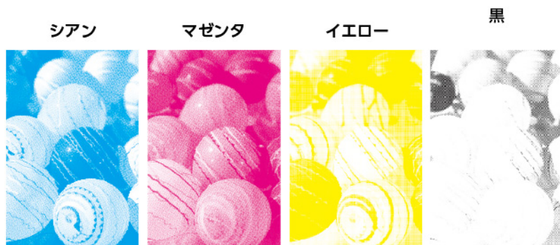
4つのカラーを重ねることによってフルカラーを出している
