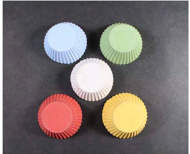
写真 1 製作したカラーセメント硬化体の例
