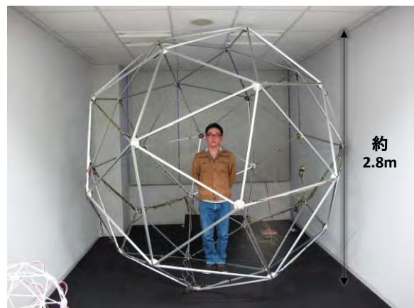
図1 ハイパワー白色LEDを付けたライティングドーム(1 st )
